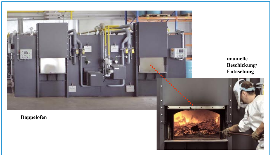
Abb. 2: Doppelbeschickungs-ofen, geeignet für den Batch-Betrieb
